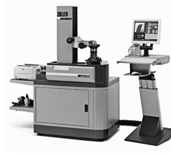
(2) ツールプリセッターによる寸法測定
