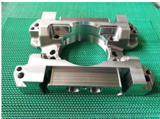
材料:S20C鍛造部品(外観寸法:
